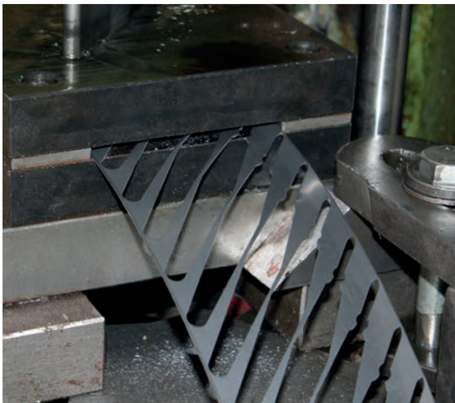
Cutting the spatulas from a stainless steel sheet. Tranciatura delle spatole da un nastro di acciaio.
