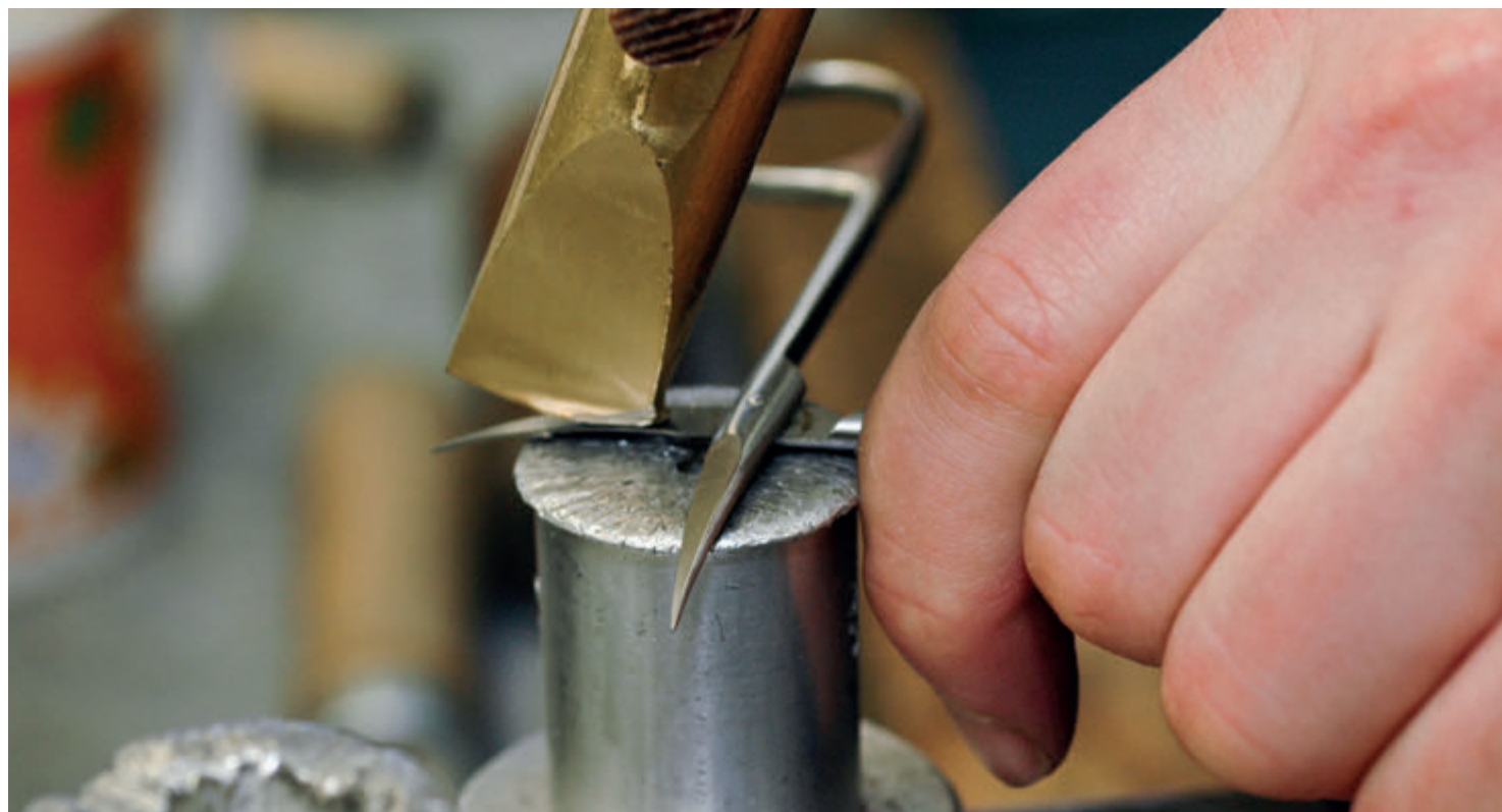
The process of "blades adjustment", for reaching a perfect alignment, carried out by expert hands. Il processo di "regolazione" del taglio delle forbici eseguito abilmente da mani esperte.
